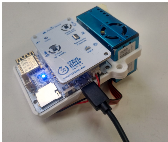
Figura 1. Ubicación del puerto USB micro en el Smart Citizen Kit
